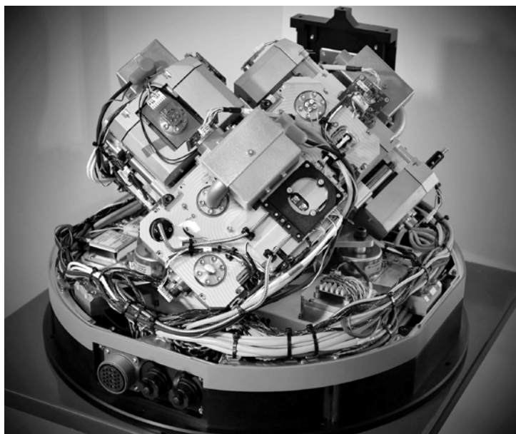
米宇宙軍が初実験に挑む量子慣性センサー＝米宇宙軍提供
