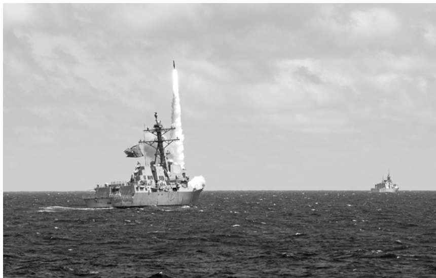
垂直発射装置（VLS）から迎撃ミサイルSM2を発射する米イージス駆逐艦。米軍や日本の自衛隊はVLSを新型潜水艦に設置し、長距離攻撃能力の強化を図る予定だ＝米国防総省提供
